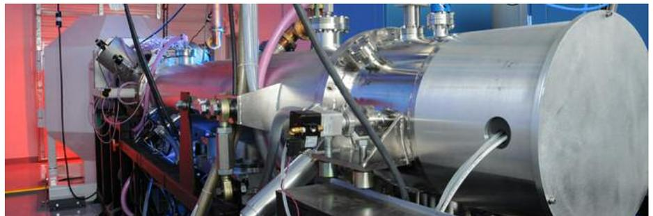
Das kompakte PULSAR® System von AccSys Technology, Inc. ersetzt als linearer Protonen-Beschleuniger die herkömmlich zur Herstellung von gamma-strahlenden Isotopen, verwendeten grösseren und aufwendigeren Zyklotrone.
